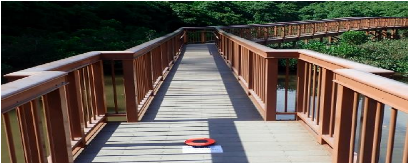
<AEROBO ® マーカーを使用し測量を実施している現場>
