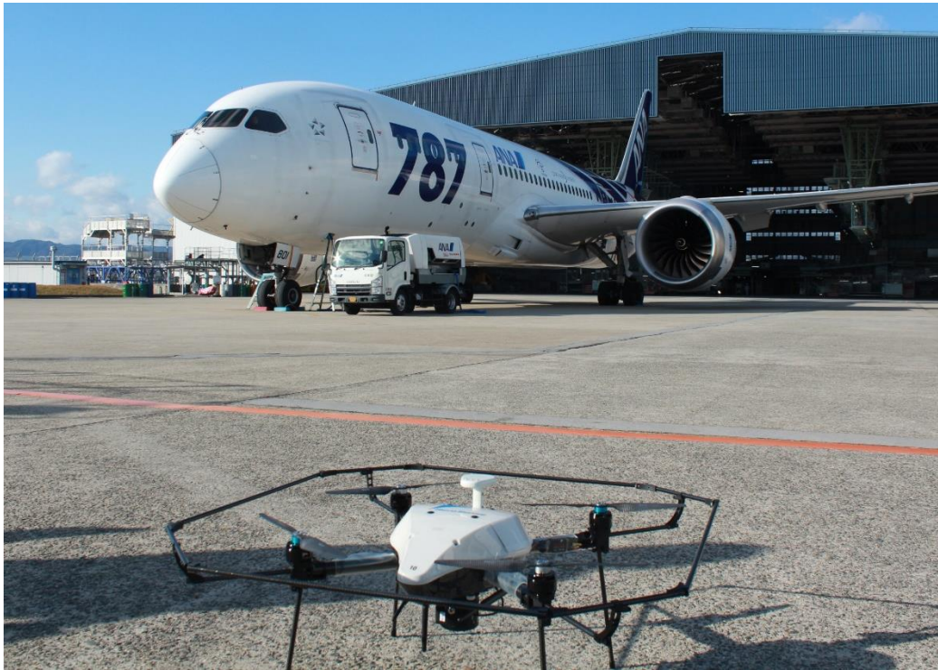
伊丹空港での実証実験の様子。航空機の周囲をAEROBOによる自動センシングを実施
