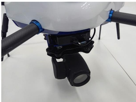
左：AS-MC03-T Full HD カメラ（ジンバル付き）搭載カスタマイズ例
