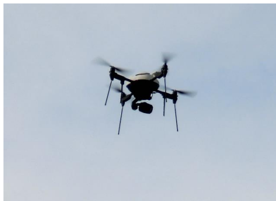
左：AS-MC03-T Full HD カメラ（ジンバル付き）搭載カスタマイズ例
